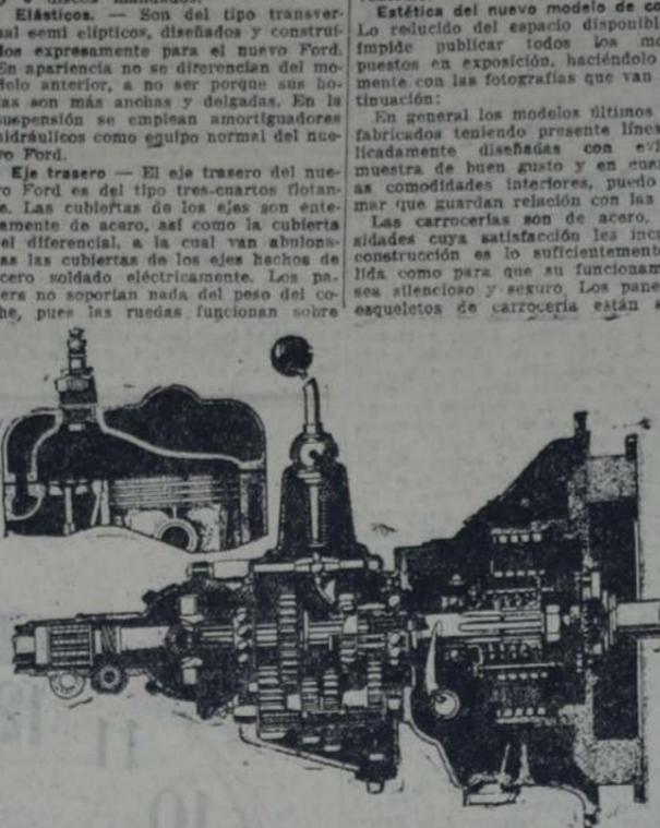
VISTAS SECCIONALES DEL MOTOR, EMBRAGUE Y CAMBIO DE MARCHA. — CULATA CILINDROS ESTILO SEMI RICARDO.
